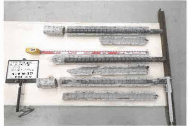
注入状況・充填率確認試験での注入部試験体
